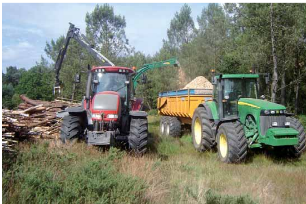
Déchetage de bois d'une première éclaircie de pin maritime
