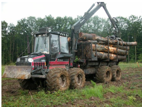
Tassement du sol par un débardeur forestier 8 x 8 (25 t en charge)
