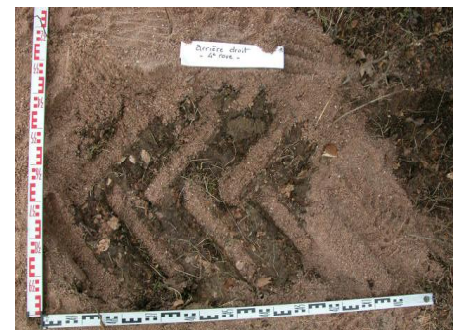
Tassement du sol par un débardeur forestier 8 x 8 (25 t en charge)
